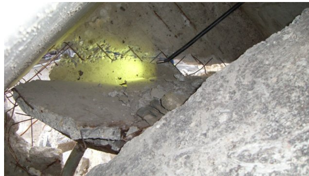
Die Sonde aus Sicht des „Verschütteten“
