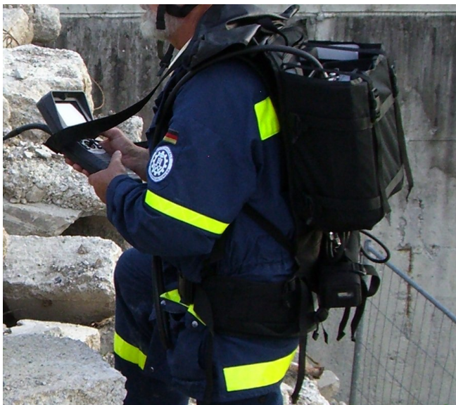
Das Bedienteil der Kamera mit Monitor
